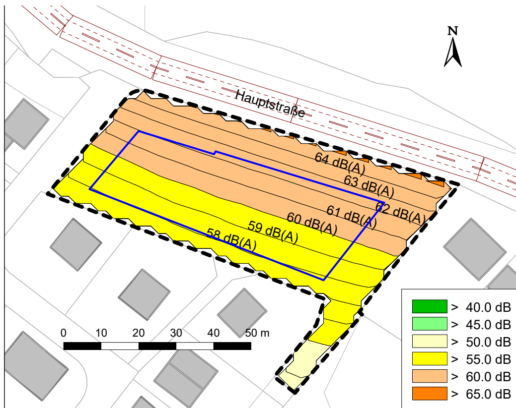
Abbildung 1: maßgeblicher Außenlärmpegel für schutzbedürftige Räume, Maßstab 1:1.000
